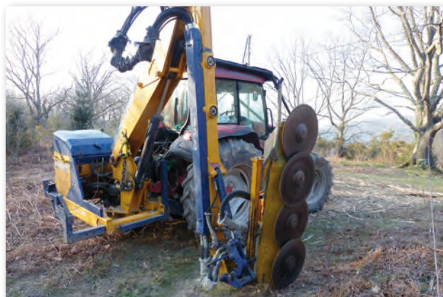
Nettoyage sur plus de 3 km de la piste de randonnée Ihiztoki-Otaiko lepoa au lamier et gyrobroyeur Ihiztoki-Otaiko lepoko mendi-bideko 3 km baino gehiagotan garbiketa xedarragailua eta «gyrobroyeur» delako tresnarekin.
